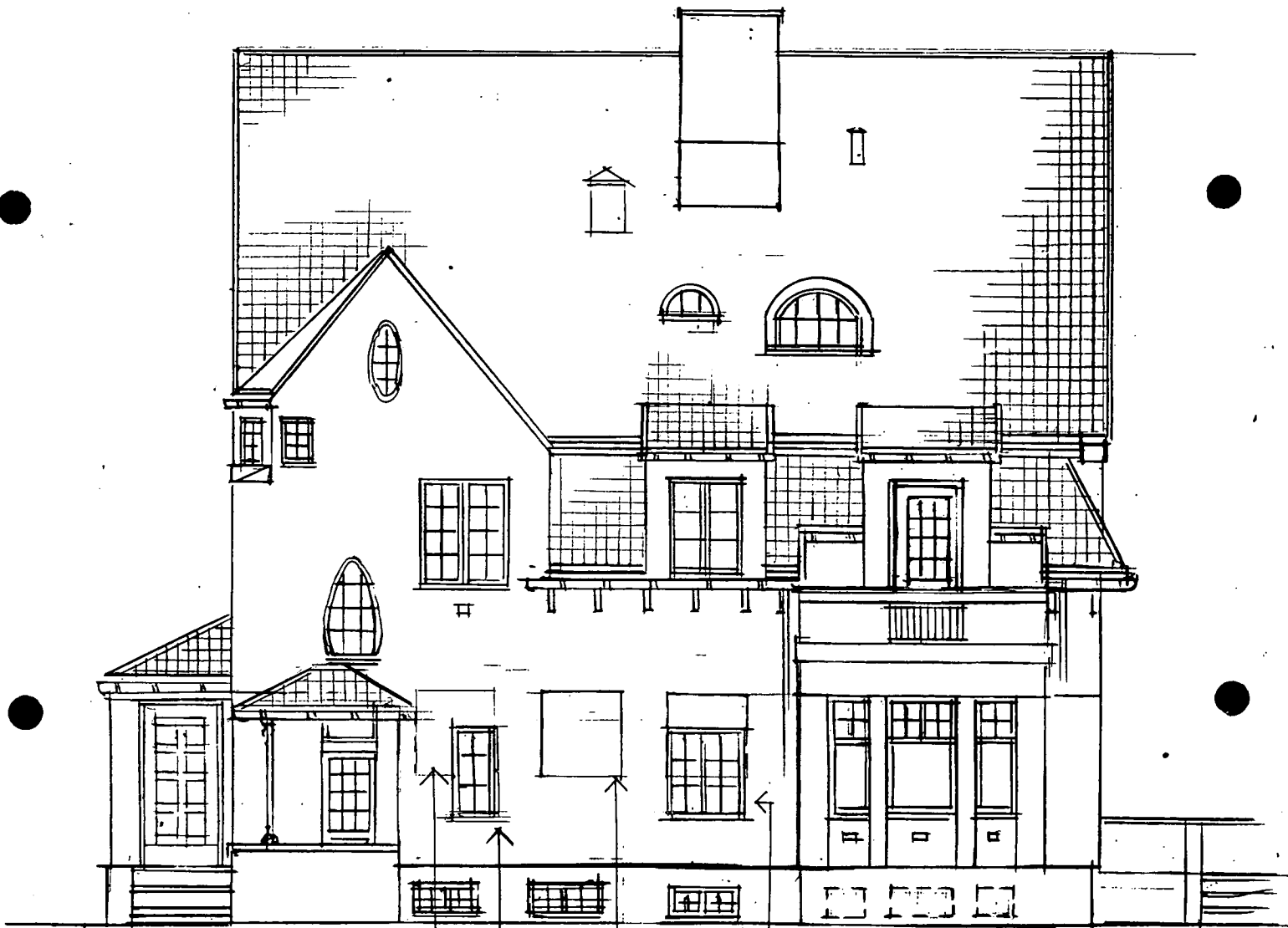
TAK OVER INNG. MOT VEST 1:100 M/DELVIS NYE VINDUER. VINDU SENKET VINDU MURES IGJENN.
